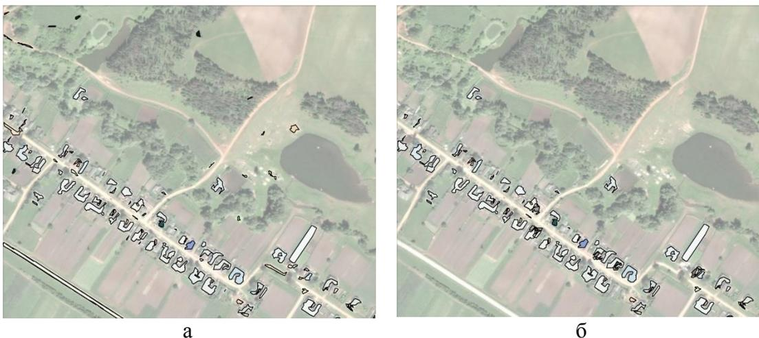
Рисунок 6 — Пример выделения на изображении зданий и теплиц (источник снимка: Google, DigitalGlobe): а — результат автоматического выделения объектов; б — результат выделения объектов экспертом
