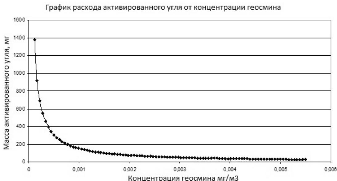
Рисунок 2.4 – Зависимость концентрации геосмина в питьевой воде от массы активированного угля применяемого для ее очистки на МУП «Ижводоканал»
