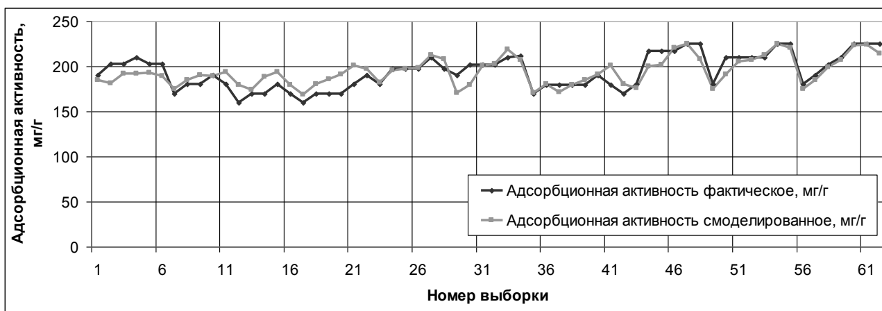
Рисунок 15 – Рисунок 14 – Обучение ИНС по фактическим значениям для параметра адсорбционная активность активированного угля
