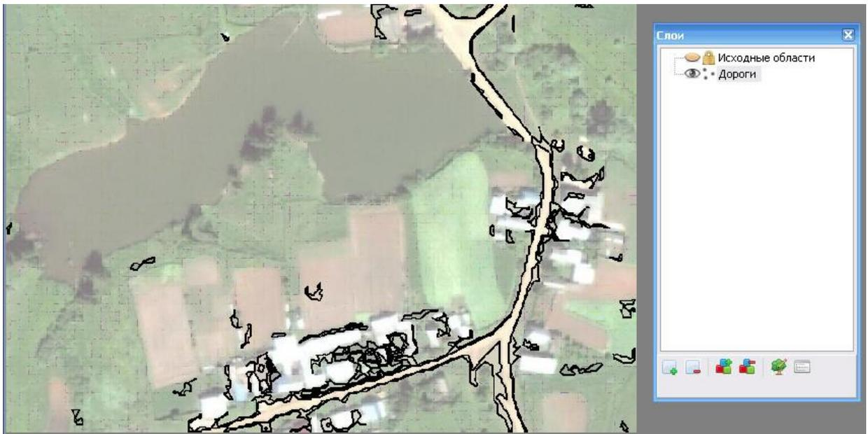
Рисунок 4.14 — Результат выделения дорог на аэрокосмическом снимке (источник снимка: Google, DigitalGlobe)
