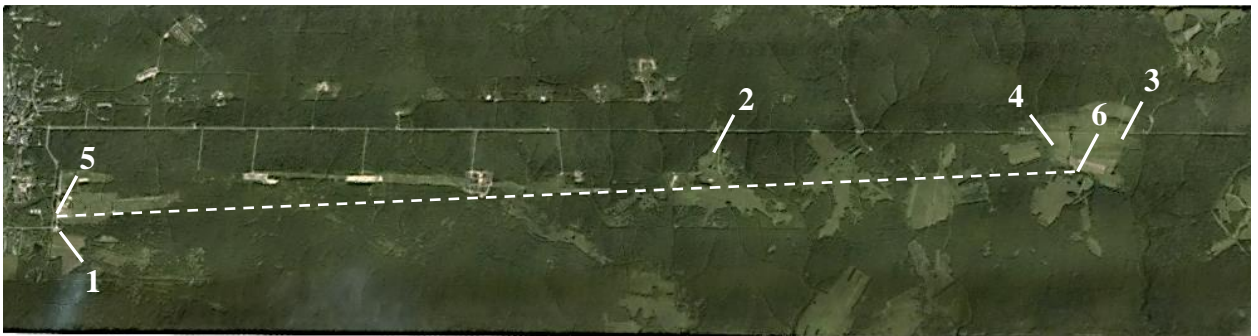
Рисунок 5.48 – Проекция траектории на карту полигона (пунктирная линия) и схема размещения объектов на карте: 1, 2, 3 – МОЭС «Вереск-М»; 4 – СВК-1; 5 – артиллерийское орудие; 6 – точка падения снаряда
