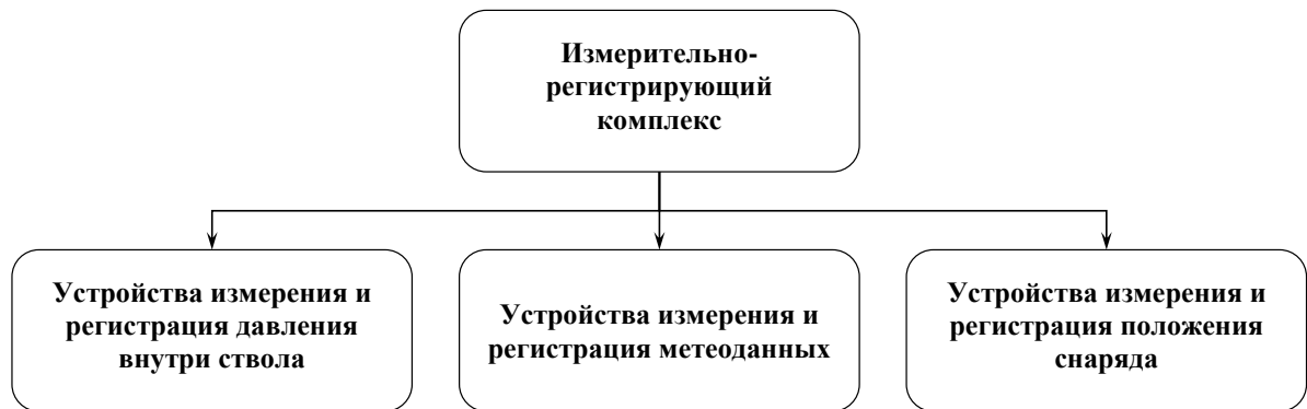
Рисунок 1.7 – Структура измерительно-регистрающего комплекса полигонных испытаний
