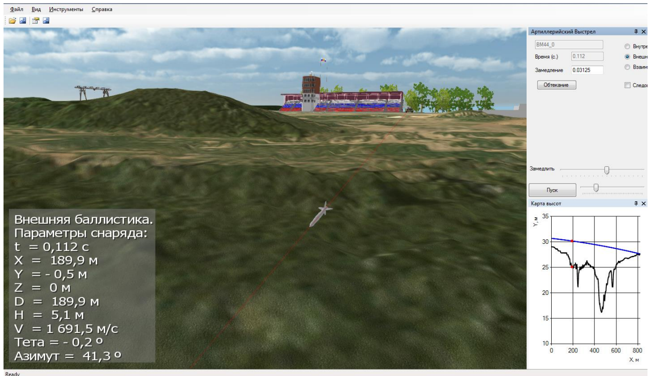
Рисунок 4.49 – Расположение снаряда на внешнебаллистической траектории
