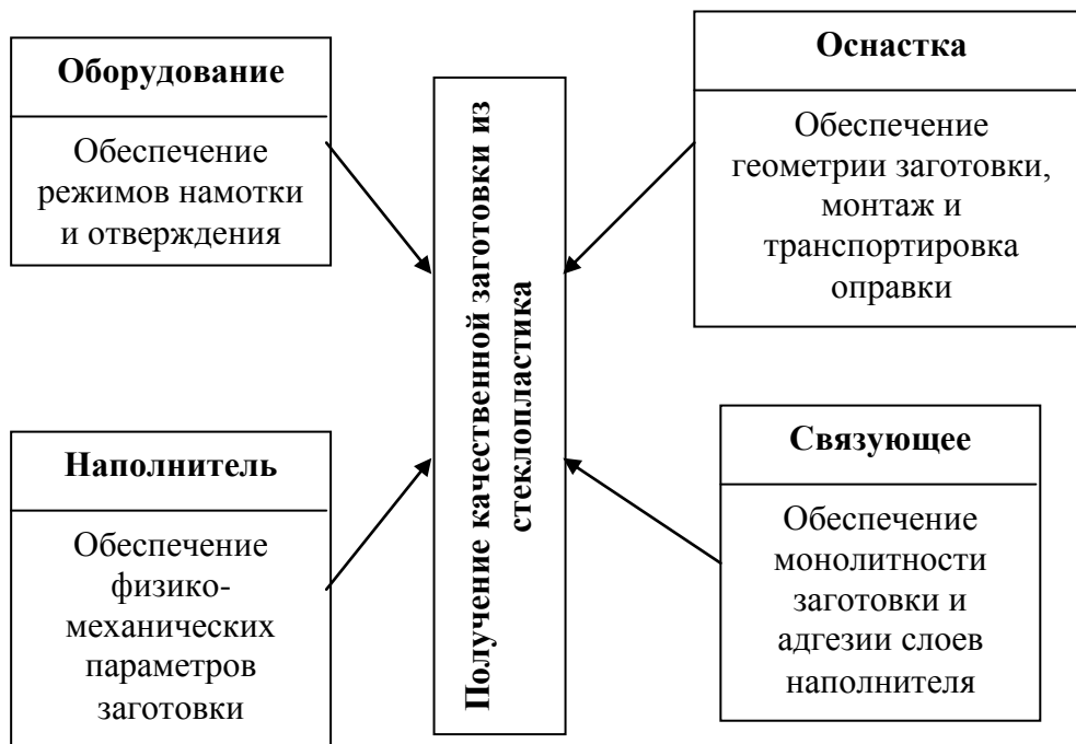
Рисунок 2.2.8 – Функциональная схема технической системы «Изготовление стеклопластиковых оболочек методом намотки»
