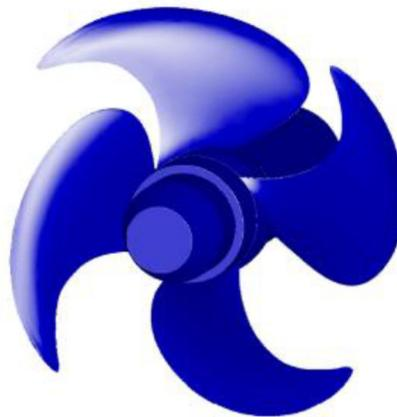
Рисунок 2.14 – Гребной винт подвесного лодочного мотора
