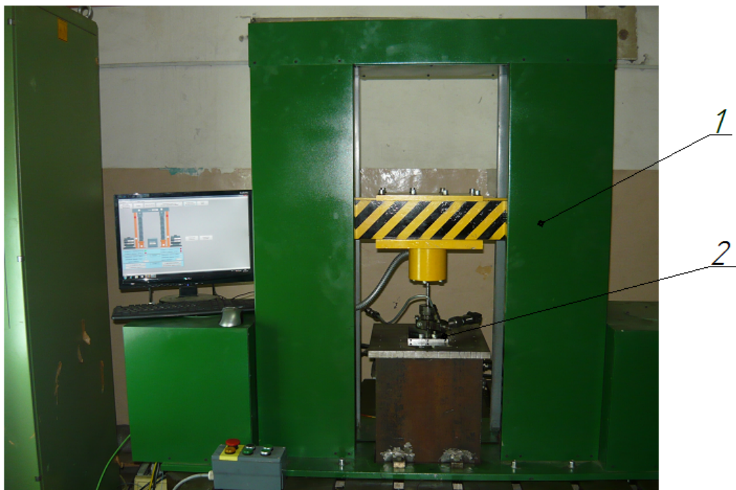
Рисунок 4.16 – Общий вид технологического комплекса для гидропрессовой сборки 1 – мехатронный пресс; 2 – технологическая оснастка
