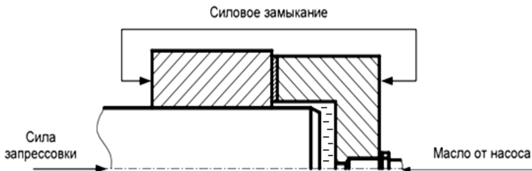
Рисунок 1.3 – Схема с подводом масла с торца соединения
