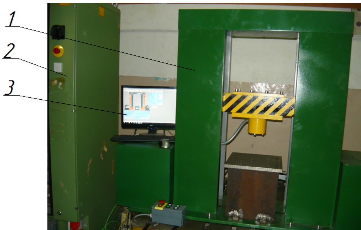
Рисунок 3.29 – Общий вид мехатронного пресса с параллельной кинематикой 1 – мехатронный пресс; 2 – шкаф управления; 3 –УУВУ;
