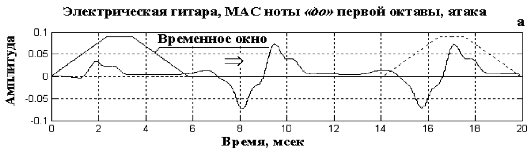
Рисунок П1.16 – Компьютерная спектральная обработка МАС ноты «до» первой октавы (электрогитара, атака).
