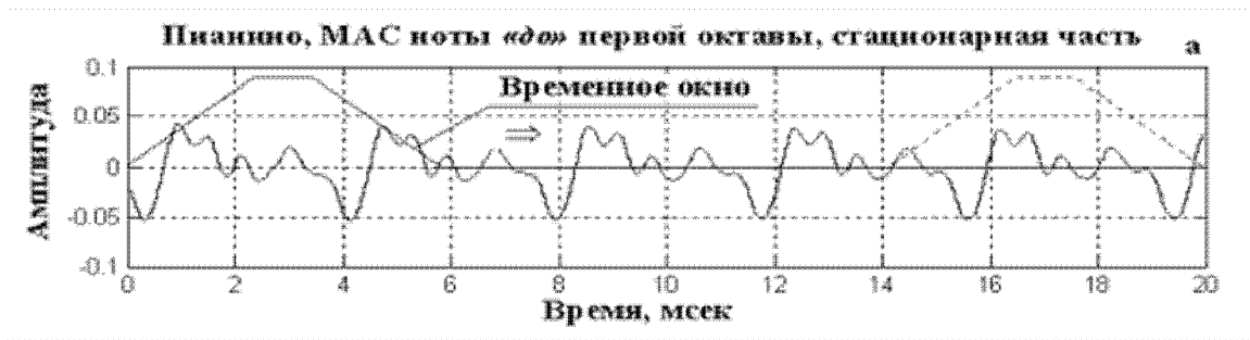
Рисунок П1.9 – Компьютерная спектральная обработка МАС ноты «до» первой октавы (пианино, стационарная часть).
