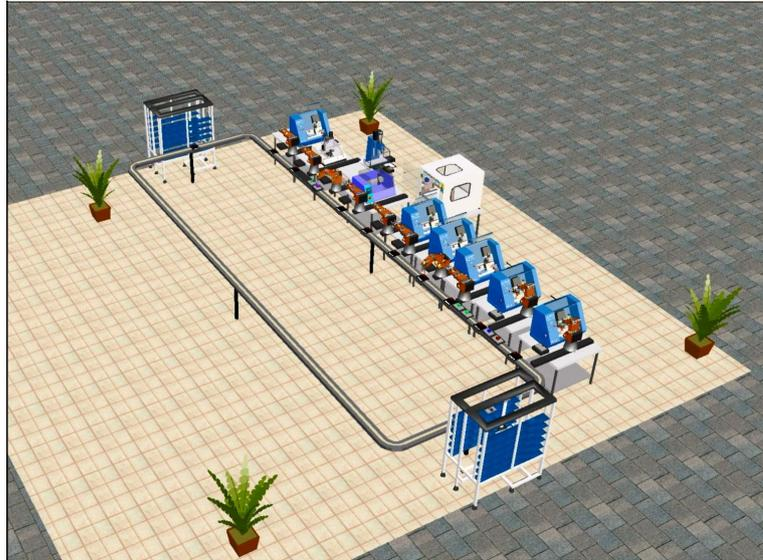
Рисунок 4.9 – Фрагмент наглядной модели для имитационного видео – моделирования работы производственного подразделения (участка) в системе *Open SIM*
