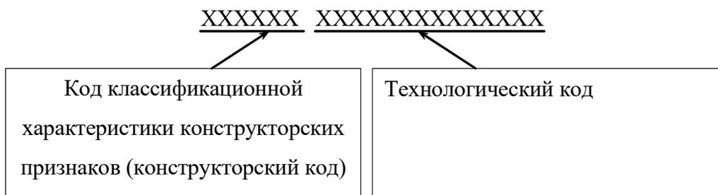
Рисунок 3.11 – Структура конструкторско-технологического кода изделий
