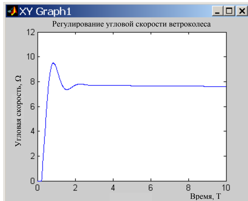
Рисунок 4.7 – График регулирования угловой скорости ветроколеса с запаздыванием 13с
