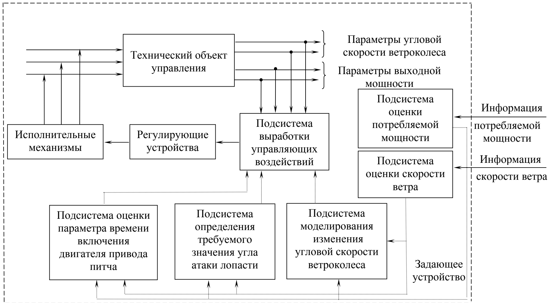
Рис. 6.1. Структурная схема автоматизированной системы управления ветроэнергетической установкой, непосредственно реализующая предложенную методику, повышающую эффективность управления
