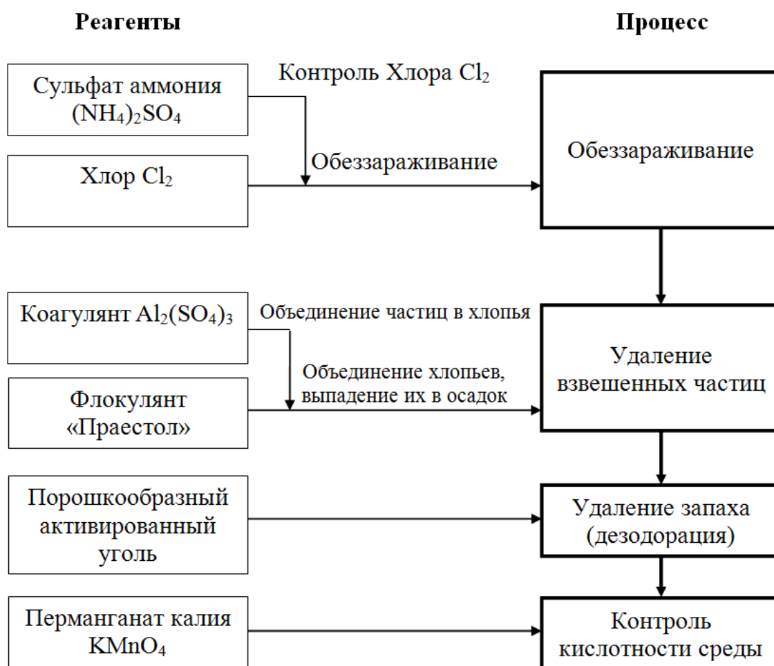
Рисунок 1.10 – Применение реагентов на очистных сооружениях
