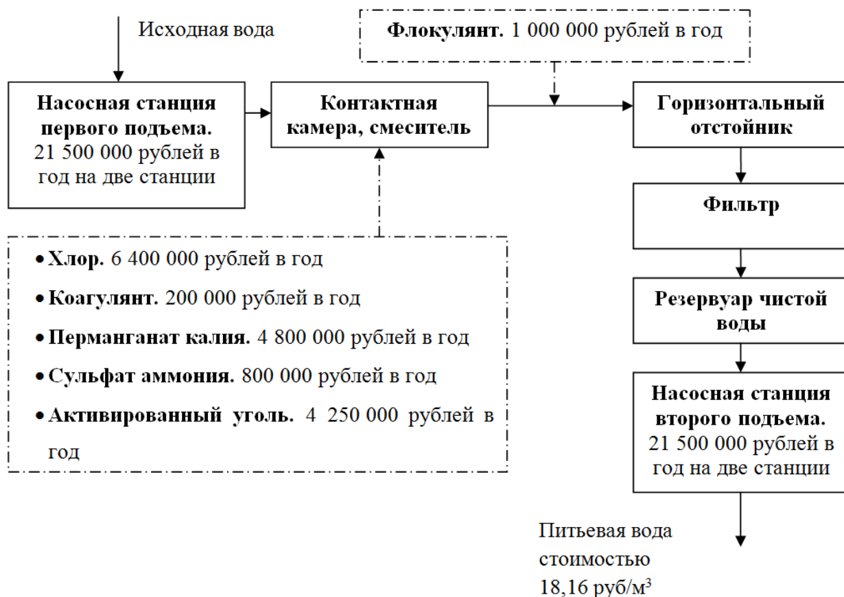
Рисунок 1.2 – Пошаговая схема очистки воды на станции подготовки воды (СПВ) «Пруд-Ижевск» со средней стоимостью каждого этапа, без учета затрат на ремонт узлов.
