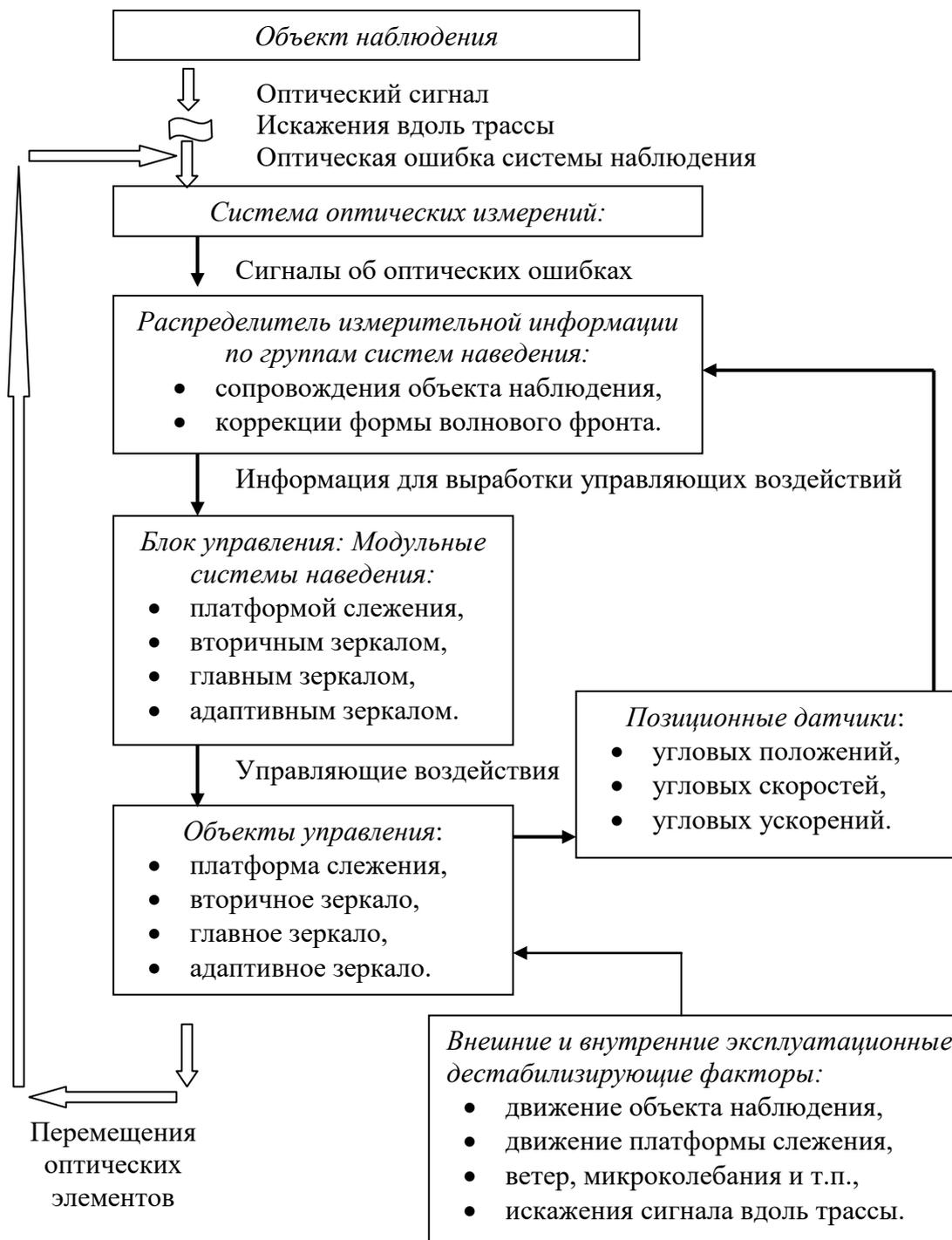
Рисунок 2.4 – Многообъектная обратная связь в составе комплекса многосистемного наведения большого оптического телескопа
