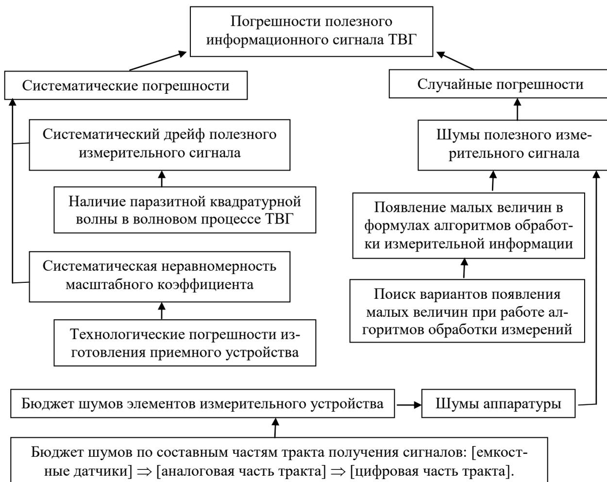
Рисунок 6.5 – Составные части погрешностей полезного измерительного устройства ТВГ и влияющие на них факторы
