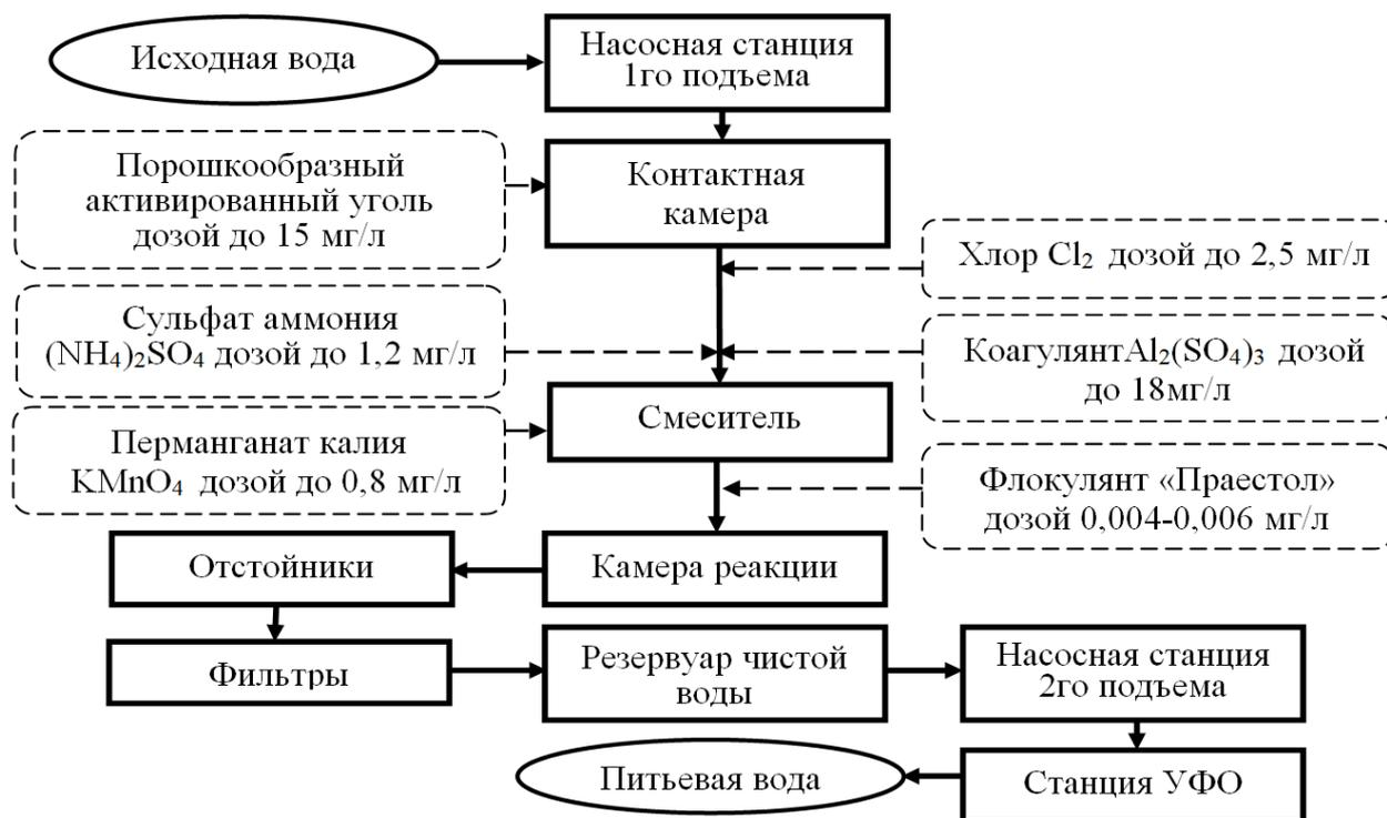
Рисунок 1. Технологическая схема на СПВ «Пруд-Ижевск»
